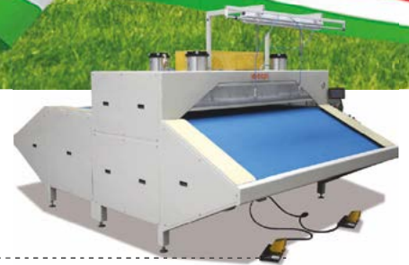
macpi 295.88 Unità automatica per stiro casacche e pantaloni Automatic unit for pants and uniforms pressing
